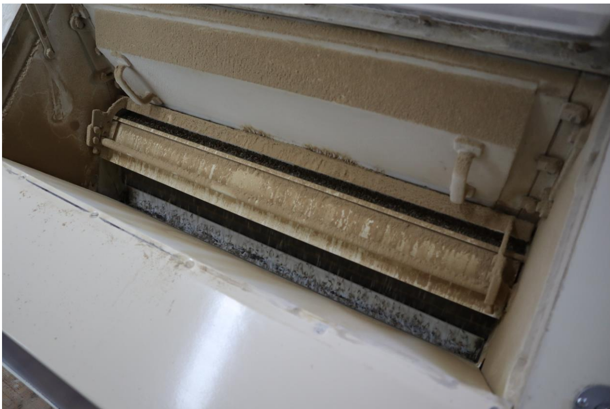
Ocelolitvinové válce v pohybu při mletí
