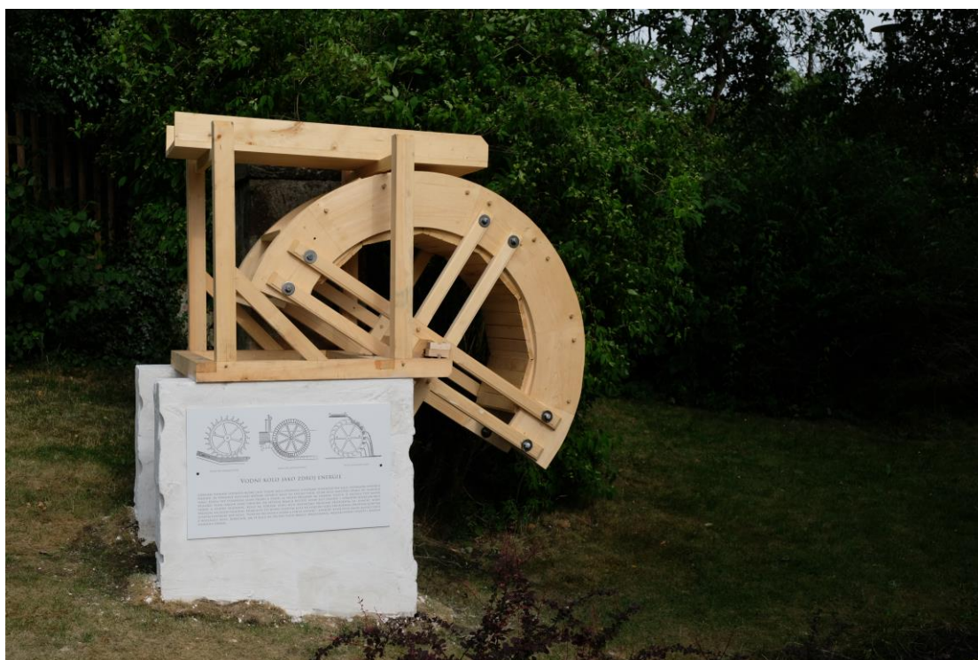
Maketa mlýnského vodního kola na horní vodu
